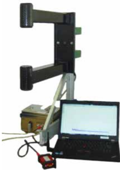
Die mobile Messgabel spürt die Verursacher von Vibrationen auf.
