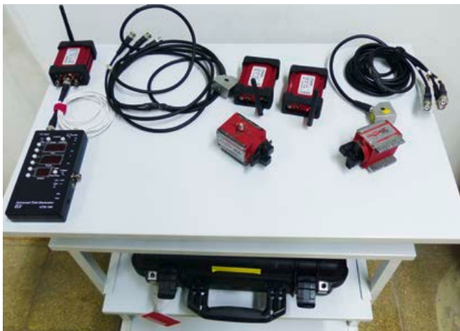
Abb. 1: Das Analyse-Kit von Heimbach-TASK auf einen Blick: Links unten der „Taktgenerator“, der zur Offline-Synchronisation verwendet wird. Links oben und inmitten des Tisches die drei Sender des Telemetriesystems, mit dem konkrete Werte ermittelt werden (Funkstrecke: ca. 150 m). Zudem der „triaxiale Beschleunigungsaufnehmer“ samt zwei „Konturenmagneten“, womit in x-, y- und z-Richtung die Walze überprüft wird.
