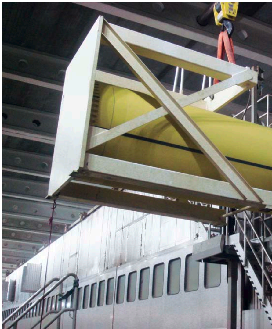
Yamabelt wird in die PM8 eingezogen.
