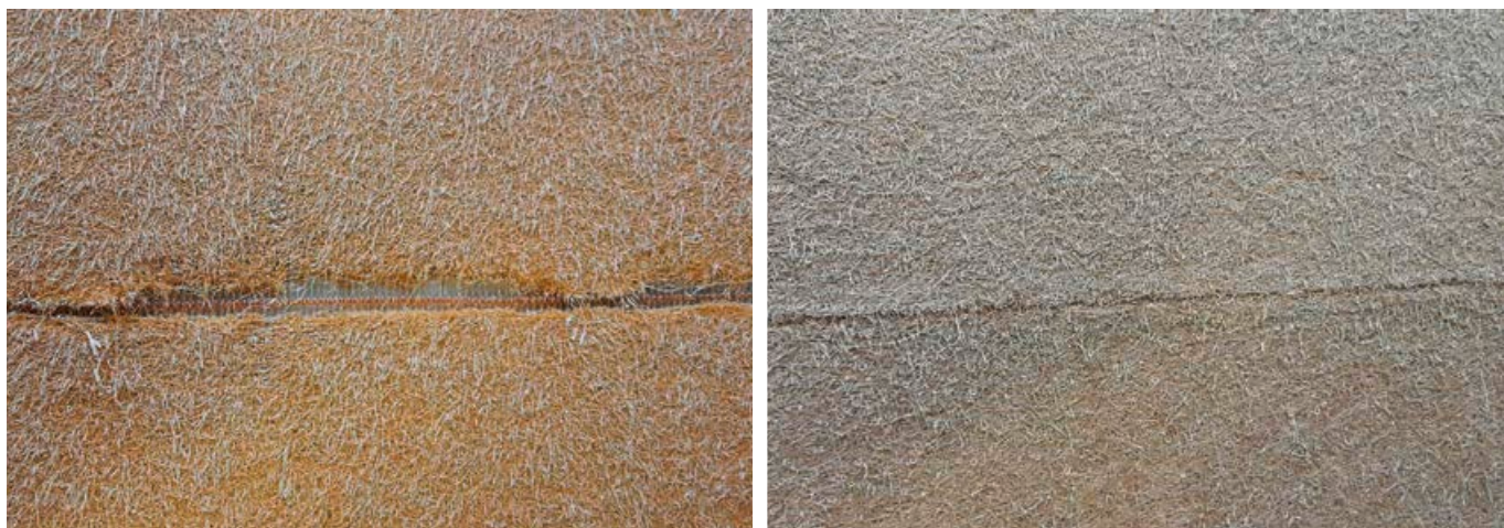
Deutlicher Unterschied auf einen Blick: gelaufener Nahtfilz „damals“ (links) und „heute“ (rechts).
