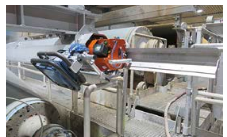
Abb. 3: Autonomer, selbstfahrender Messwagen ohne Trägeranschlüsse.
