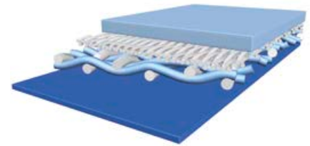
Papierseite: Fadensystem Unterbau: Einzelmonofilamente in MD und CD Offenes, leichtes Filzdesign
