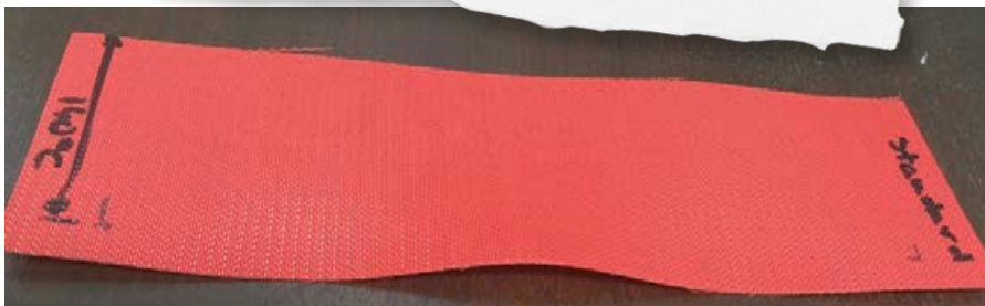
Foto 1: Ein welliger Rand in Maschinenrichtung.
