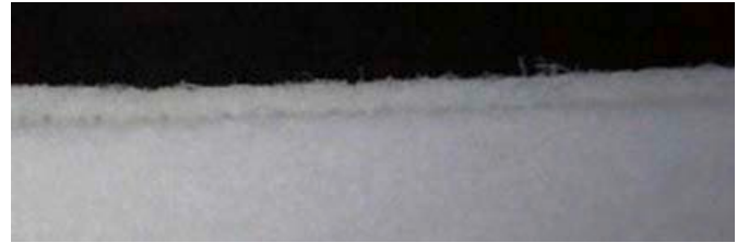
Foto 3: Ein echter Fortschritt gegen Verschleiß – heutige Ausführung der Nahtüberlappung.
