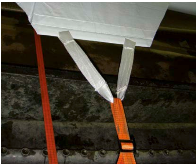
Foto 3: Nur eine Gurtschnalle im Einsatz (nach oben gewölbt).
