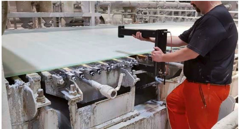
Foto 1: Messpunkt Fünf vor der Siebsaugwalze.
