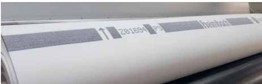
Der Laufstreifen dient als Hilfsmittel z. B. bei Walzeinstellungen
