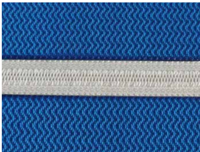
Spiral- / Schließnaht in einem Transportband für Lebensmittel
