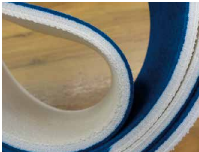
Pastierband für die Herstellung von Bleibatterien
