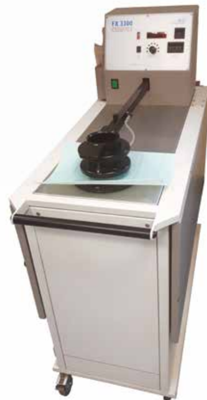
Abb. 1: Messung der Luftdurchlässigkeit
