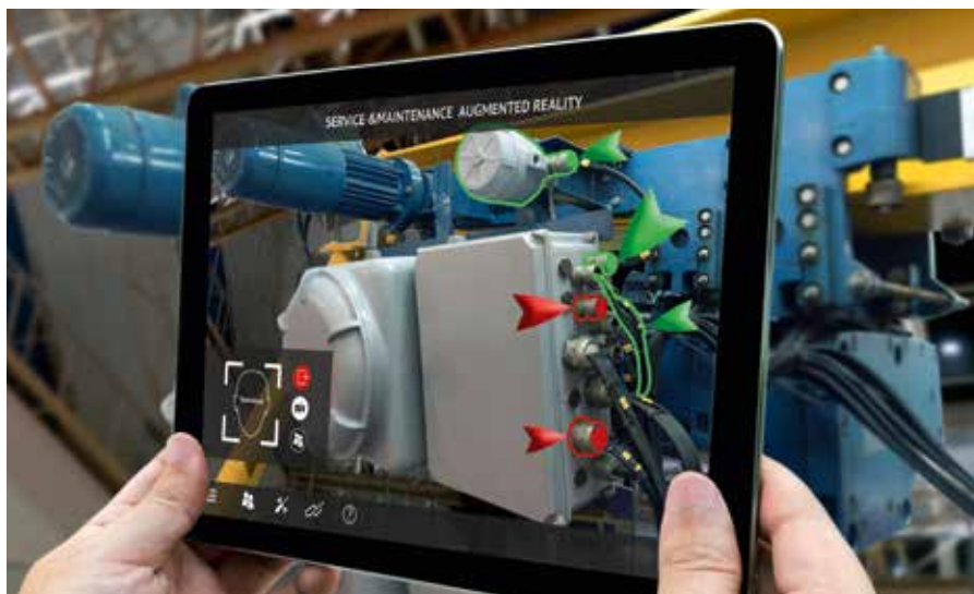
Assistenzsystem zur Fehlerlokalisierung am Maschinenantrieb
