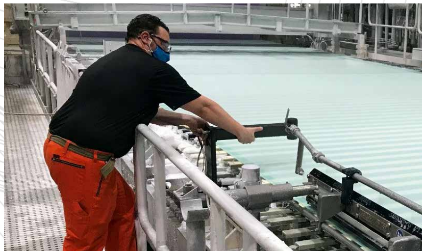
Abb. 3: Einsatz der ODIN-Messgabel in der Siebpartie
