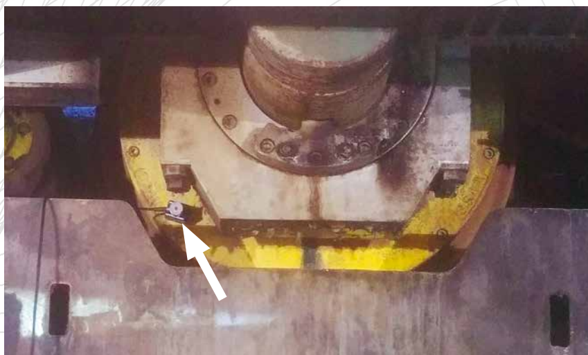
Figure 7: Position du capteur de vibration sur le palier du rouleau supérieur de la 2ème presse
