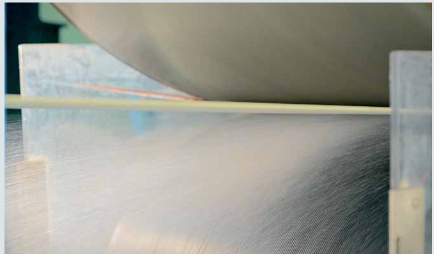
Abb. 4a: Gute Nip-Entwässerung
