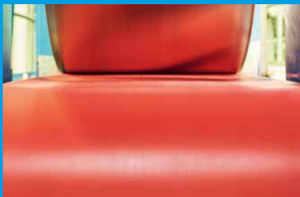
Gute Beschaberung – keine feuchten Streifen
