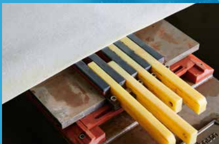
Randbegrenzer am Rohrsauger teilweise fehlerhaft eingestellt
