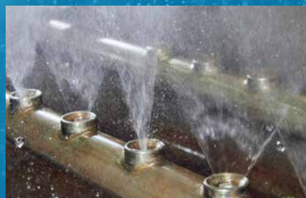
Jets de buses défaillants, non-laminaires
