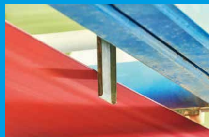
Réglage correct d'une palette guide-toile
