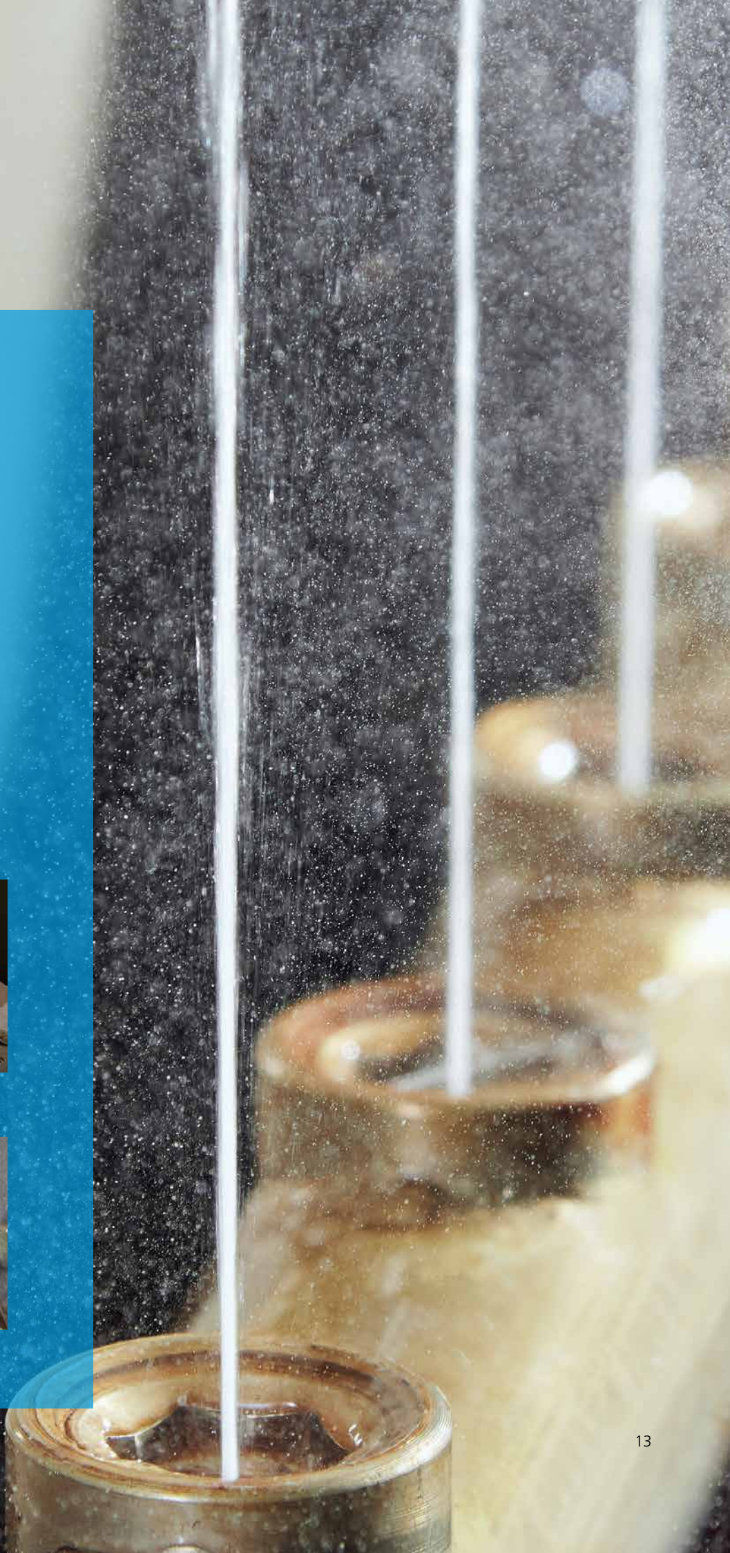
Jets de buses défaillants, non-laminaires
