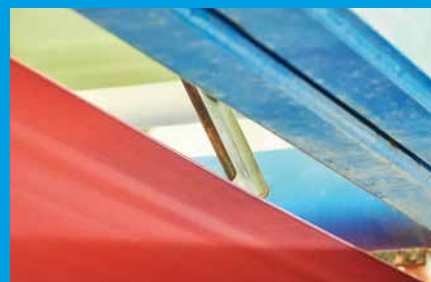
Mauvais réglage d'une palette guide-toile
