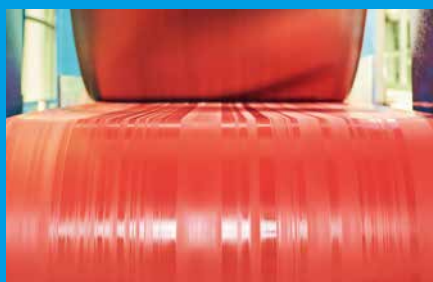
Bandes humides causées par un doctorage défaillant
