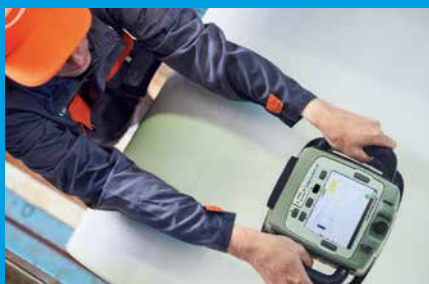
Mesure du contenu d'eau
