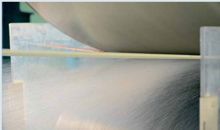
Fig. 4a : bon égouttage au nip
