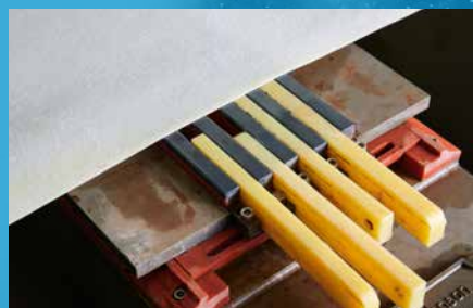
Réglettes de bordures de caisse aspirante mal disposées
