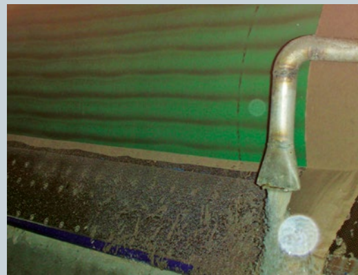
Abb. 1: Facettenbildung auf der Walzenoberfläche kann Ursache oder die Folge von Barring sein.
