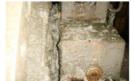
Abb. 6: Stark verschmutzte Spannscheibe
