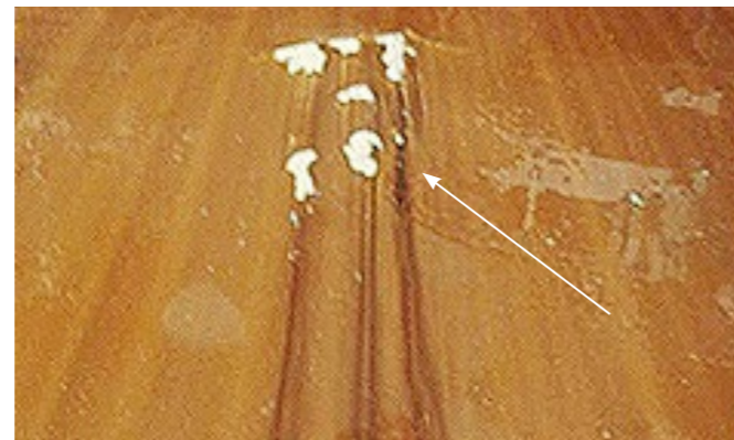
Abb. 2: Delaminierter Belt in Folge von Kratzern
