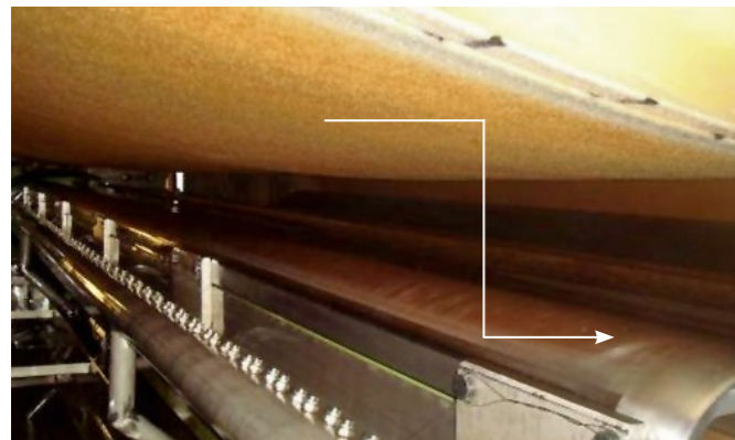
Abb. 1: Kratzer an der Schuhplatte
