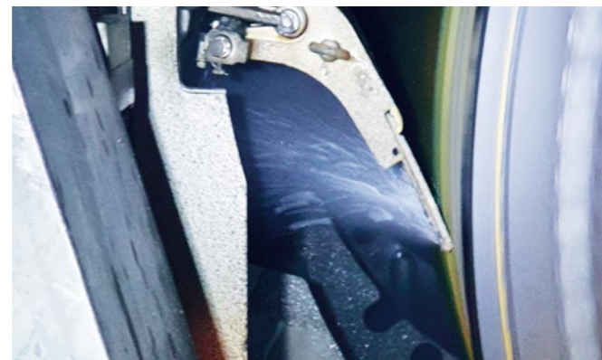
Abb. 4: Im Zuge des Beltwechsels sollte auch die Beschaberung erneuert werden
